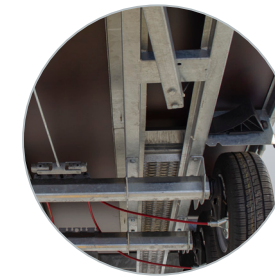
Sterk chassis met geïntegreerde rijplathouders
