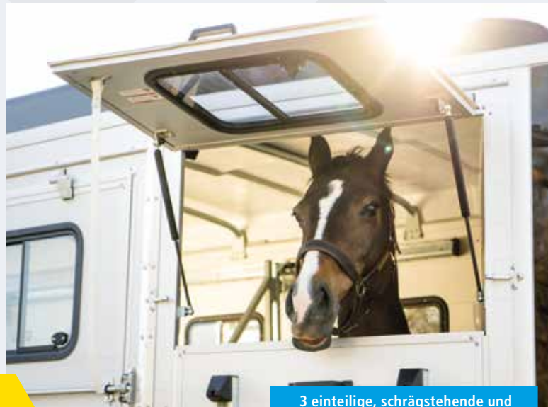
3 einteilige, schrägstehende und schwenkbare Alu-Trennwände
