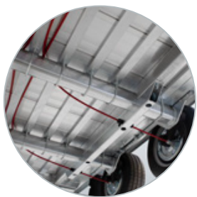
IJzersterke vloerondersteuning door vele kokerprofielen
