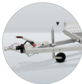
Lange dissel uit stalen kokerprofielen
