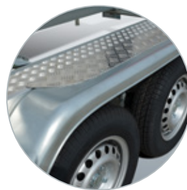
Spatscheren met extra versteviging
