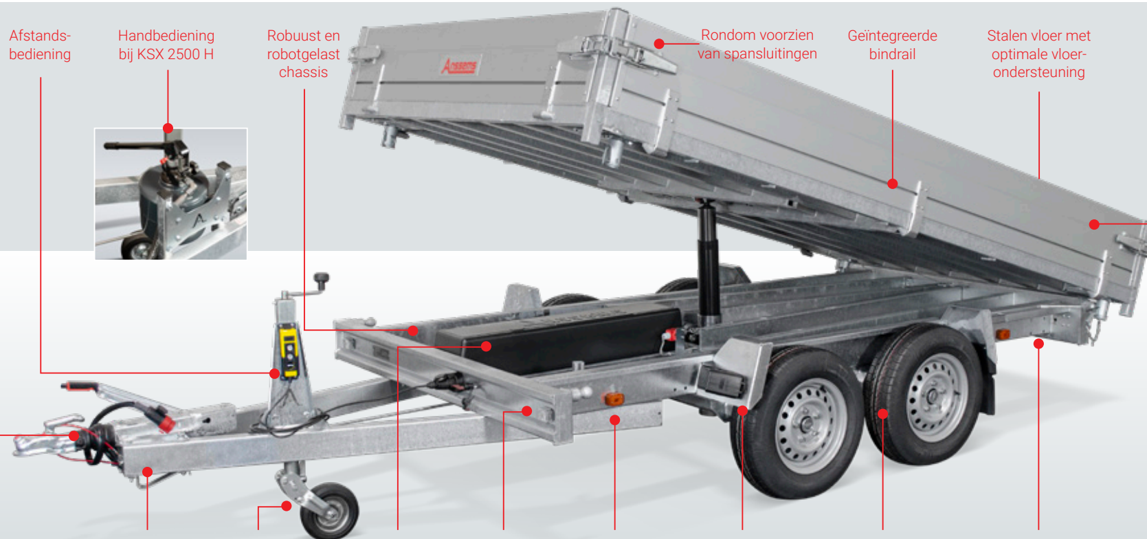
Lange dissel uit kokerprofielen
