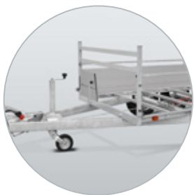
Robotgelast chassis met vaste reling en voorrek
