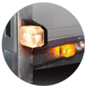
Voor- en zijmarkeringsverlichting
